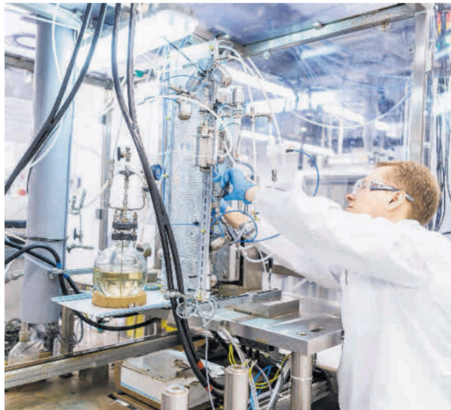
Batteriesystemforschung bei Innolith in Bruchsal. Ein Wissenschaftler testet ein Batteriemuster mit einem anorganischen Elektrolyten. Foto: Innolith
